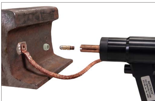
3. Připravte materiály a vložte do pistole kolík a objímku.
